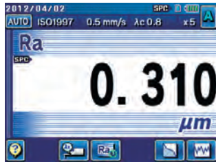
1-parameter display: one parameter measurement result
